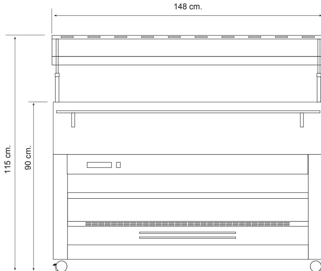
Possibilità di inserire contenitori **gastro - norm** , profondità **Max 150 mm**
